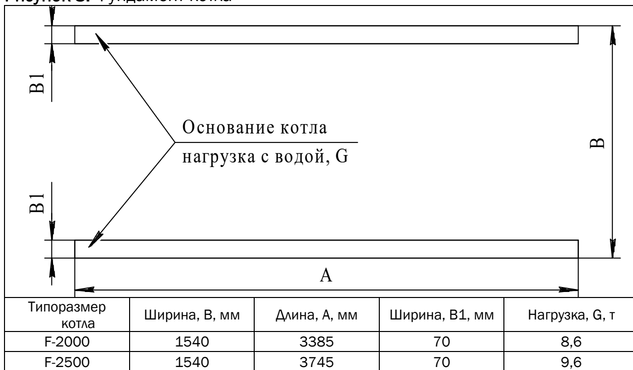
Рисунок 8. Фундамент котла
